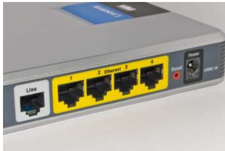
Connectors d'ADSL. Font: Asim18, amb llicència GNU
